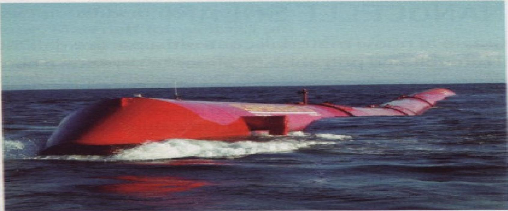
▲ I sistemi per lo sfruttamento del moto ondoso della Ocean Power Delivery trasformano in energia elettrica il movimento dei loro componenti flessibili al passaggio dell'onda. Poiché si tuffano dentro le onde, le macchine Pelamis sono in grado di resistere alle mareggiate più intense.
