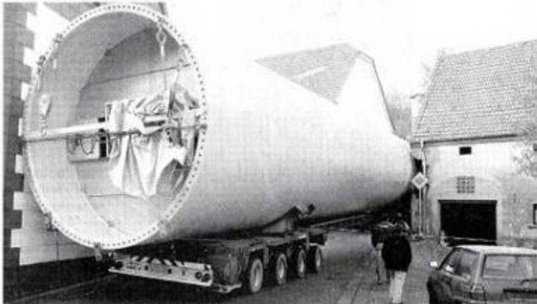
Niederkirchen ist einfach zu eng: Links passt zwischen dem 45-Meter-Mast und der Mauerwand kein Stück Papier mehr. Rechts hat der Mast bereits Teile aus dem Mauerwerk herausgebrochen. Geplant ist, weitere Teile der Mauerwand zu entfernen, damit der Lkw weiter fahren kann. Foto: afa
